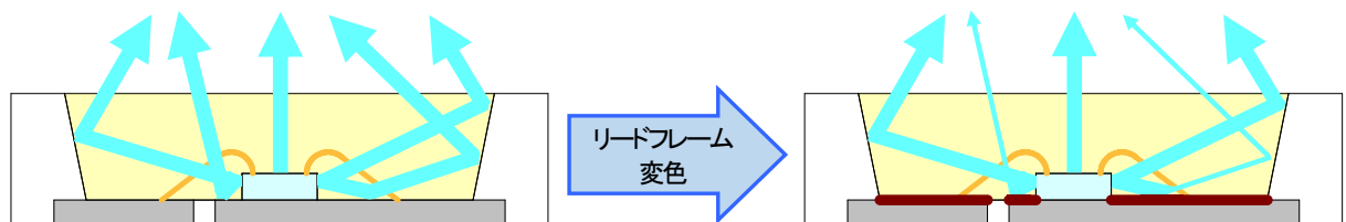
図 2. 光度・光束低下メカニズム
