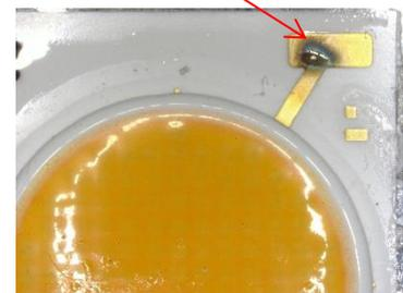
図 14. COB の電極端子焼損例
