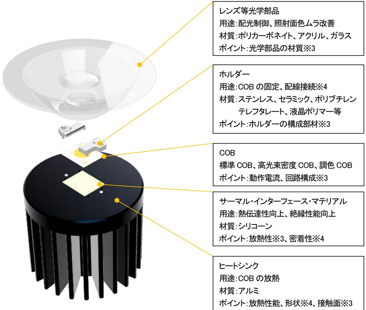
図 10. COB を用いた照明器具
