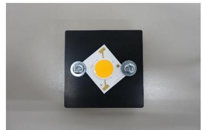
図 16. COB のネジ締め固定
