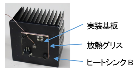
写真3 評価した光源の構成
