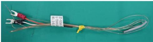
図 12. 熱電対 (K 熱電対)
